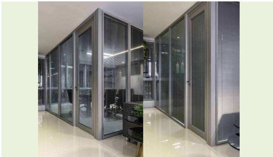
Divisória para ambientes, tipo piso teto vidro total com persiana, com estrutura confeccionada em alumínio anodizado fosco, em módulo padrão de 1250 mm de largura por até 2700 mm de altura (pé direito) e na espessura de 90 mm, com fechamento in loco, quando preciso, sob medida variável de acordo com o projeto.
