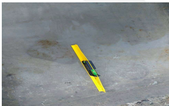
Base para realização do slump ou flow – nivelada e umedecida
