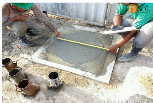
Flow dentro das especificações – 700+/-50mm
